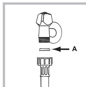
1. Vložte tesnenie A do koncovej časti prítokovej hadice a pripojeniu k uzáveru studenej vody so závitom 3/4" (vid' obrázok). Pred pripojením hadice nechajte vodu odtieť, až kým nebudete priezračná.
