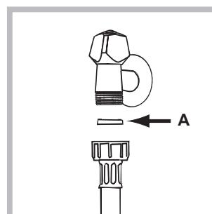
1. Introduceți garnitura A în extremitatea tubului de alimentare și înșurubați-l la un robinet de apă rece cu gura filetată de l'газ (vezi figura). Înainte de conectare, lăsați apa să curgă pentru a se limpezi.
